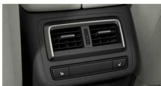
Las salidas de la ventilación con persianas en la parte posterior de la gran consola central frontal proporcionan un flujo de aire ajustable independientemente a los pasajeros en la parte posterior del vehículo. Los asientos izquierdo y derecho posteriores están climatizados con un control de temperatura de tres fases.
