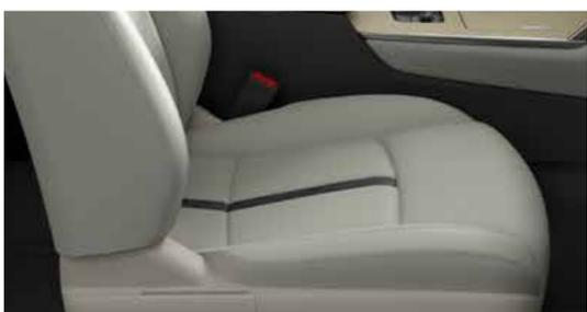
El sistema de ventilación de los asientos frontales retira el aire caliente y húmedo de las áreas donde el cuerpo está en contacto con la superficie del asiento para una mayor comodidad. Las perforaciones están distribuidas de manera amplia y uniforme en el respaldo y el cojín del asiento para una máxima eficiencia, y el sistema ofrece un control de tres fases.
